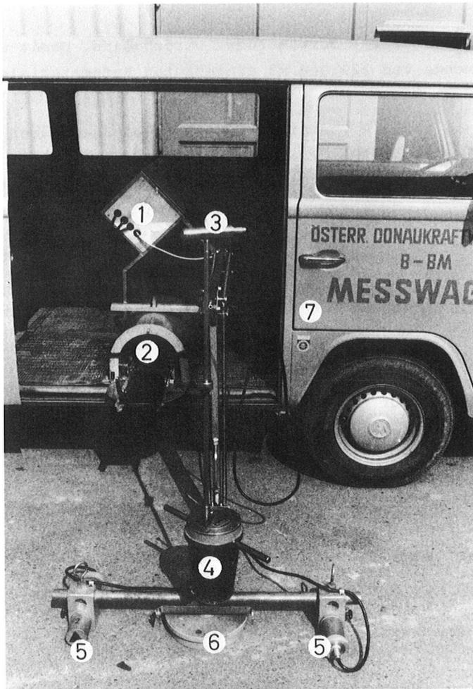
Abb. 6 : Radiometrische Bodendichtesonde
