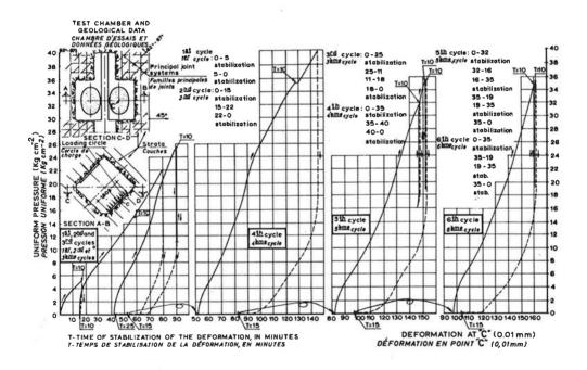
b) Vergleich der Verformungen in der Mitte und am Rand der Lastfläche
